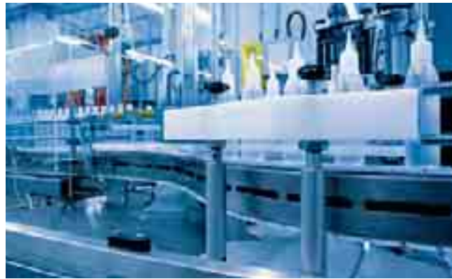
El higiénico sistema de acero inoxidable VarioFlow transporta de forma flexible y segura las botellas vacías de champú para el llenado y el cerrado
