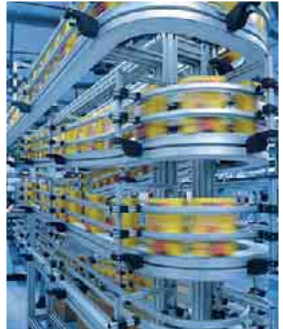
Transporte y acumulación en un sistema. Con velocidades reguladas, el sistema VarioFlow se adapta a las oscilaciones en la producción de las máquinas
