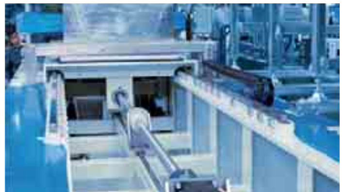
Unidad de avance de una instalación de envasado de sopa en polvo; patines de bolas sobre railes en ambos lados para un desplazamiento de la unidad preciso y muy dinámico; accionamiento mediante husillo de precisión central
