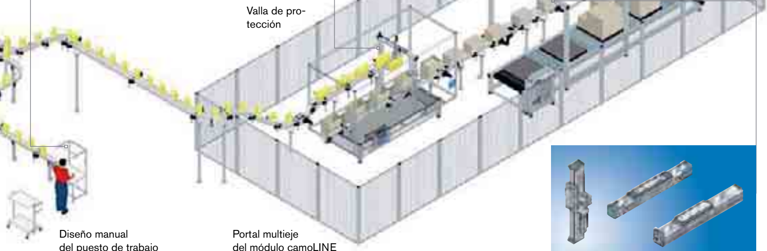
Módulos lineales para montar sistemas multiteje para la carga de paletas
